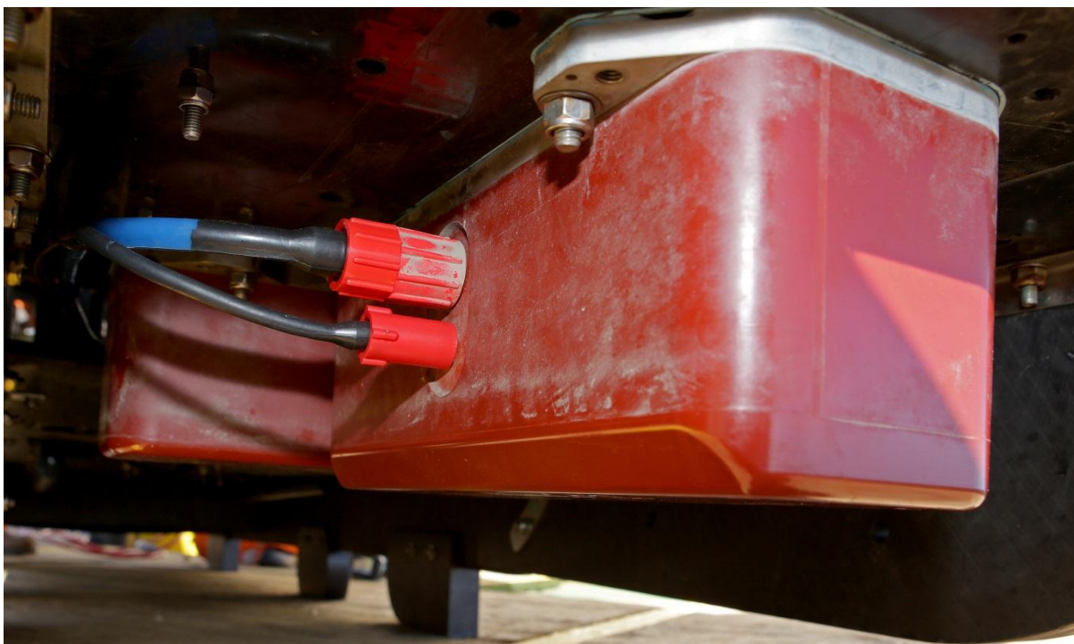
拖鱼‘龙太子’设备之深海 EM2040 多波束测深仪。来源：澳洲运输安全局(ATSB)，ABIS Chris Beerens, RAN.
